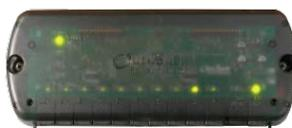
HUB - менеджер системных связей (коммуникаций) это основа для создания Вашей соединенной в сеть системы преобразования электрической энергии на основе оборудования Outback Power Technologies. Outback HUB соединяется стандартным Ethernet CAT5 кабелем с разъёмами RJ45. Использование HUB - необходимо и достаточно для полнофункциональной настройки, управления и мониторинга системы электрообеспечения Outback Power при помощи системных контроллеров серии MATE.
