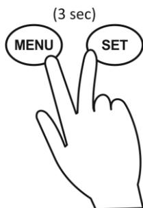
Если требуется перезапустить процесс заряда вручную, не отключая линию переменного тока, одновременно нажмите кнопки MENU и SET на 3 сек. После этого зарядное устройство автоматически перезапустит процесс заряда, перейдя на стадию основного заряда (Bulk).
